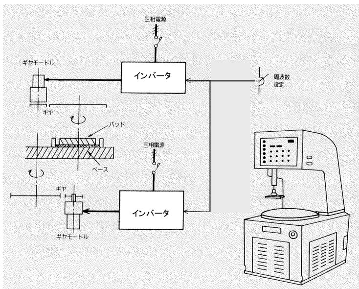
研磨するものに合わせて、インバータで、パッドとベースの回転速度を変更します。
