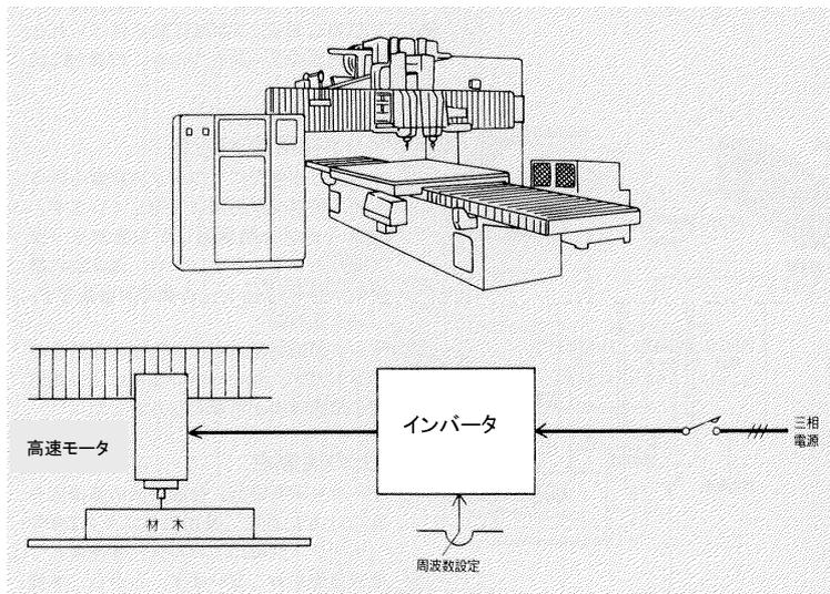
木工の彫刻、面取り、切抜きなどの加工を行う木工フライス盤です。高速モータとの組み合わせで、簡単に高速回転で研削できます。
