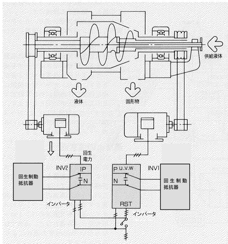
液体を供給し、その中に固形物と液体を分離する遠心分離機(デカンタ)にインバータを適用した例です。
