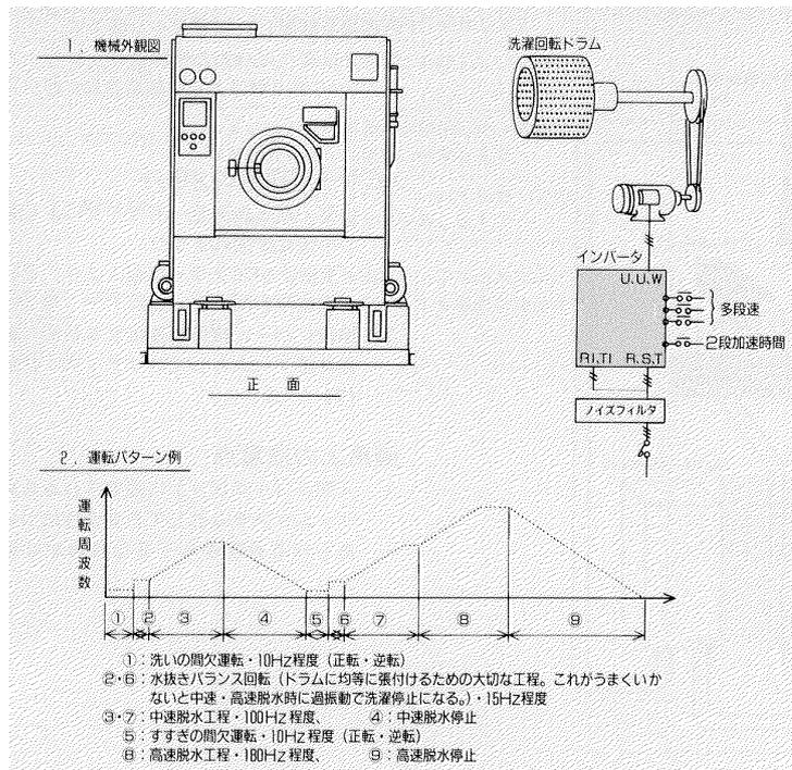
洗い、すすぎ、バランス中速脱水、高速脱水の5工程を1台のモータを使い各工程に最適な速度でインバータ制御している例です。
