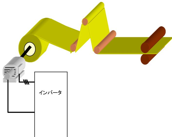
紙や電線などのラインシステムにおける、巻取り制御にインバータを使用した例です。
